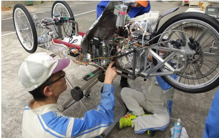
写真：エンジンのオイル漏れ、保温材の剥がれ、インジェクタ詰り等、チェック
