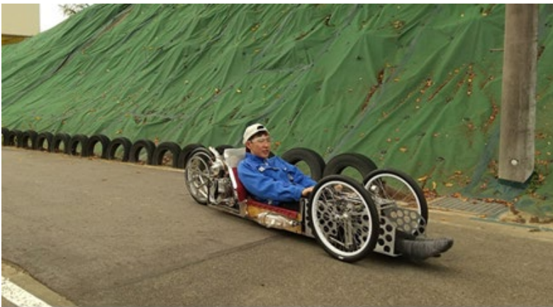
KOBA 周りで走行し、エンジンの掛り具合、アクセルレスポンス、惰行走行速度等を確認
